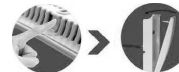
2. При наличии проводного интерфейса проденьте провода через центральное отверстие в задней крышке и подсоедините их к разъёму в соответствии с Инструкцией по работе с внешним интерфейсом.
